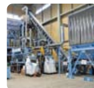
FBAS 流動層式アルミ選別装置。ミックスメタルの比重選別に用いるアルミを回収する。
