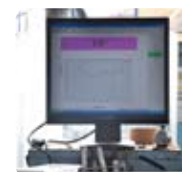
プラスチック判別機 プラスチックに近赤外線を照射し反射光からプラスチックの種類を判別する。
