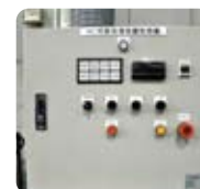
HC冷媒回収装置 ノンフロン冷蔵庫の冷媒であるHC冷媒を回収する。
