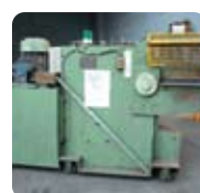
アリゲーターシャー 被覆電線をナゲット機や剥線機に投入可能な長さに切断する。
