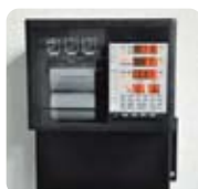
デマンド監視装置 電気使用量を計測し設定したデマンド目標値を超過しそうな場合にアラームを鳴らす。
