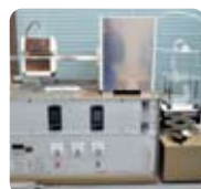
燃焼管式試験器 微粉碎されたプラスチックを燃焼させ試料中の塩素含有量を分析する際に用いる。
