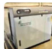
コンプレッサー 工場の様々な設備・工具で使用される圧縮エアを作り出す。
