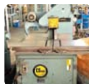
ラジエーターカット機 ラジエーター端のアルミと銅以外の部分(主に鉄)を切断する。
