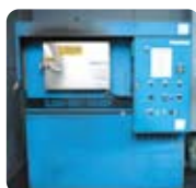
発砲スチロール溶融機 発砲スチロールを熱で溶かし体積を減らす装置。
