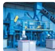
FBS 流動層式比重選別装置。混合プラスチックの比重選別に用いる。
