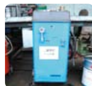
オイル回収機 廃二輪車に残っているオイルを回収する。
