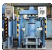
トリム機 洗濯機のプラスチック製洗濯槽底部に埋め込まれている鉄板を除去する。
