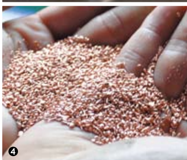
①導入されたナゲット機。製品のでき具合をチェックしながら微調整を行う。②ナゲット機に投入する前にケーブルの種類等を手作業でチェック。③ケーブルの付属品等も全て手作業で外し、外された部品も分別する。④でき上がった銅リサイクル原料(赤銅)。
