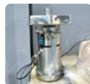
ハンマークラッシャー プラスチックの成分分析を行う際の前処理として微粉碎を行う。
