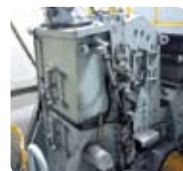
捻砕機 高速回転するロータに取付けられたリングハンマーで粗破碎された冷蔵庫等を捻砕する。
