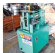
剥線機 被覆電線を上下から切り込みを入れ被覆素材を剥ぎ取り銅と選別する。
