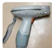
金属分析器 X線を利用し金属の組成を分析する。
