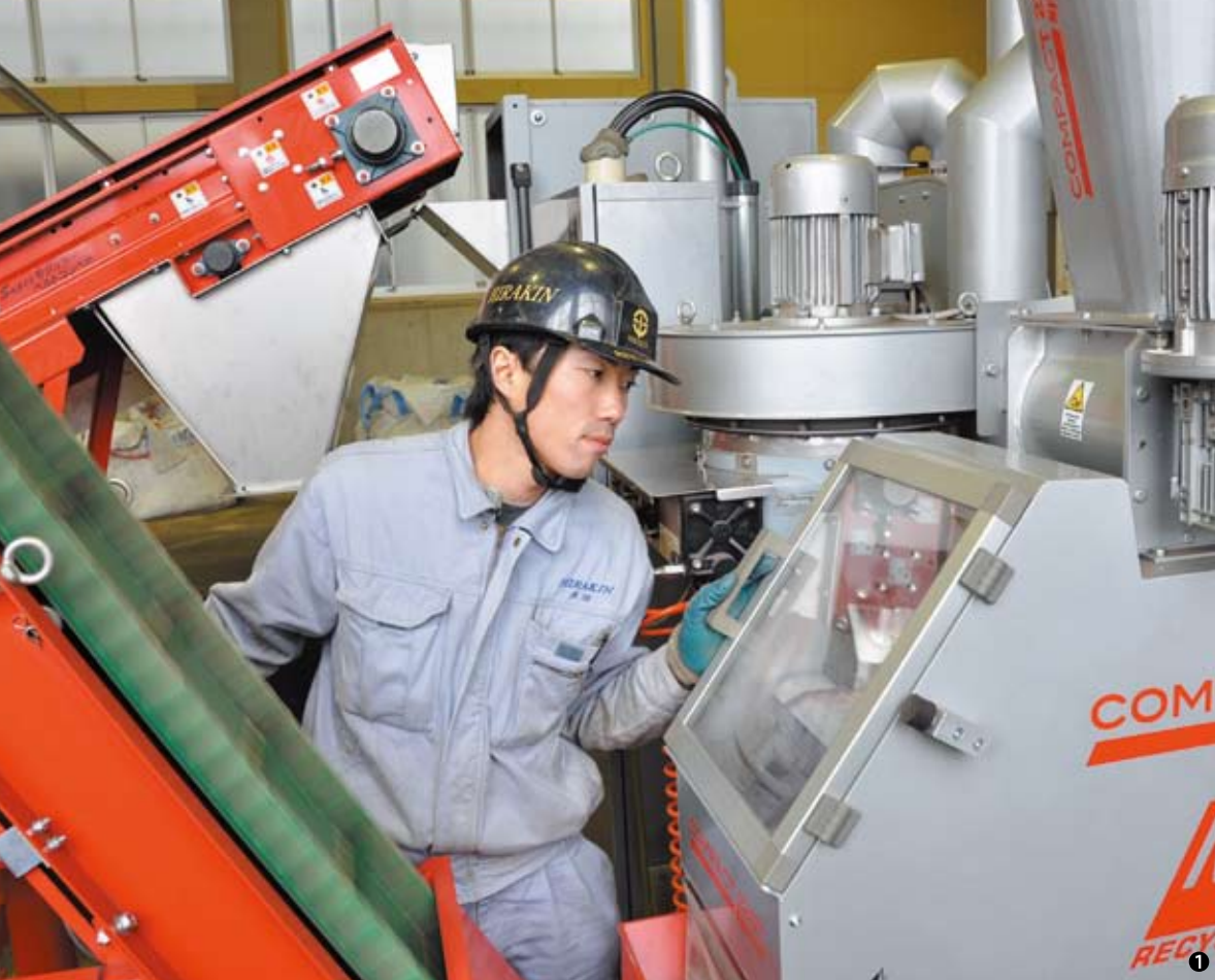
①導入されたナゲット機。製品のでき具合をチェックしながら微調整を行う。②ナゲット機に投入する前にケーブルの種類等を手作業でチェック。③ケーブルの付属品等も全て手作業で外し、外された部品も分別する。④でき上がった銅リサイクル原料(赤銅)。
