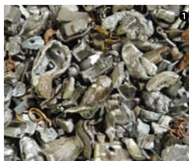
①西大寺工場に持ち込まれるミックスメタル。同じように見える銀色の金属も実はアルミや亜鉛といった異なる素材が混在している。②世界にただ1台の乾式比重差選別装置（FBAS）。③FBASを使い高精度に選別されたアルミリサイクル原料。④FBASやその他の選別機械を使用する前に、ミックスメタルにどのような素材、成分、形状が含まれるか等、人の目と機械を使い分析する。
