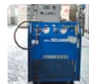
冷媒フロン回収機 エアコン、冷蔵庫、自動販売機、自動車等に含まれる冷媒フロンの回収に用いる。
