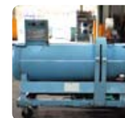
フロン分離機 冷媒フロンと共に回収されるオイルに溶け込んでいるフロンの分離を行う。
