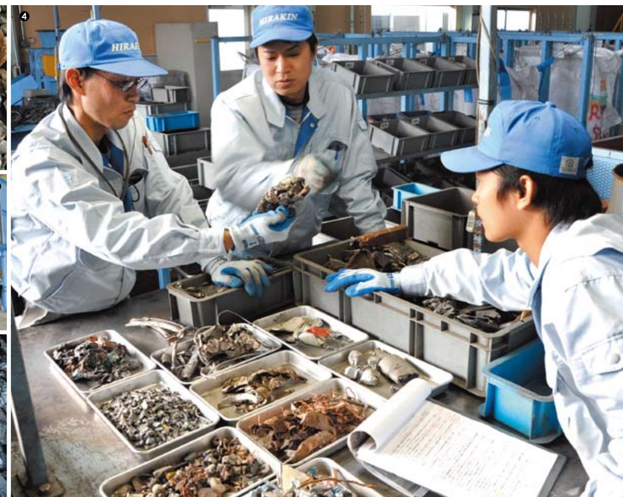
①西大寺工場に持ち込まれるミックスメタル。同じように見える銀色の金属も実はアルミや亜鉛といった異なる素材が混在している。②世界にただ1台の乾式比重差選別装置（FBAS）。③FBASを使い高精度に選別されたアルミリサイクル原料。④FBASやその他の選別機械を使用する前に、ミックスメタルにどのような素材、成分、形状が含まれるか等、人の目と機械を使い分析する。
