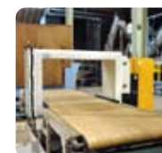
金属検知器 プラスチックに付着している金属を検知し検知時にはコンベヤが自動停止する。
