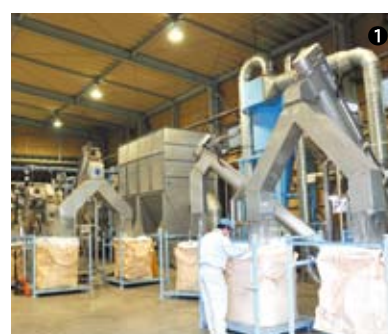
①開発されたプラスチック選別装置。②専用の選別槽で比重差選別を繰り返す。③選別後のプラスチック原料は、水とアルコールの二つの溶液を使い、比重や不純物が含まれていないか等の検査を行う。この検査にパスしないと出荷されない。④ミックスプラスチックから原料化された高純度プラスチック。
