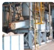
ウレタンプレス機 断熱フロン回収済みのウレタンを圧縮する。
