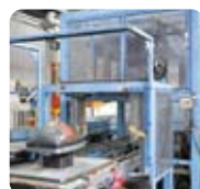
バンド除去装置 ブラウン管側面の防爆補強バンドを高周波による熱で膨張させ取外す。
