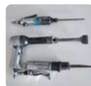
エア工具類 圧縮エアが動力源の工具で家電等を手解体する際に用いる。
