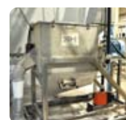
ツイスター プラスチック表面に付着している水分や汚れの除去を行う。
