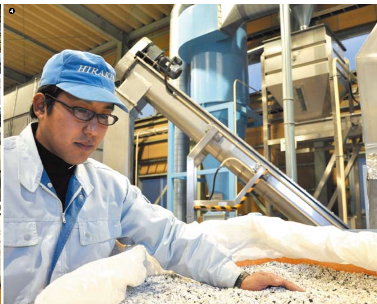
①開発されたプラスチック選別装置。②専用の選別槽で比重差選別を繰り返す。③選別後のプラスチック原料は、水とアルコールの二つの溶液を使い、比重や不純物が含まれていないか等の検査を行う。この検査にパスしないと出荷されない。④ミックスプラスチックから原料化された高純度プラスチック。
